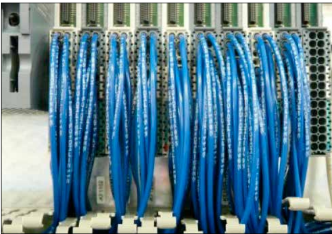
W firmie Alexander Bürkle połączenia są etykietowane automatycznie za pomocą oprogramowania EPLAN.
