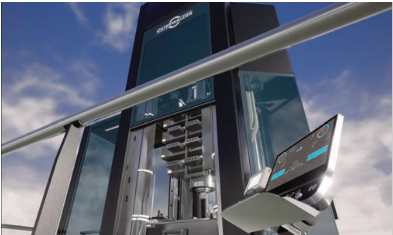
OPP 2000 to pierwsza wielopoziomowa prasa o sile nacisku do 2000 kN wyposażona w napęd elektryczny zamiast hydraulicznego. Fot: Osterwalder AG
