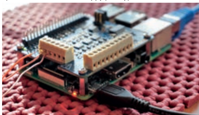
2 MCC-118 - widok od strony terminali śrubowych
