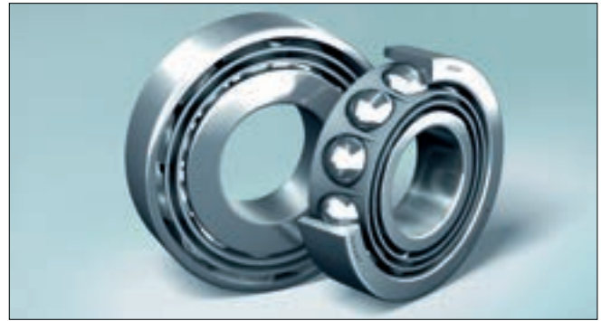
Łożyska kulkowe skośne wzdłużne z serii TAC są wykorzystywane do przenoszenia sił osiowych w serii śrub kulowych S-HTF.
