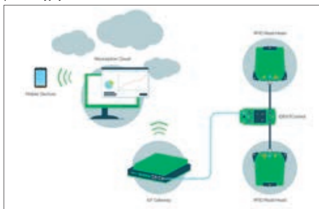
Dane z czytników RFID są przesyłane przez bramkę IoT do chmury Neoeption, gdzie są one dostępne przez cały czas.
