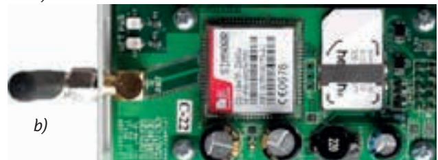
Rys. 2 a). Koncentrator LB-480 od strony przylączy pomiarowych, b). moduł LB-499 AIN (dwa takie moduły umiejscowione są w portach 1 i 2)
