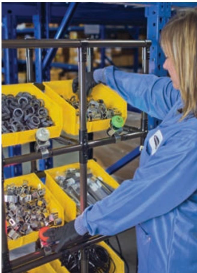
Rys.2. W aplikacjach pick-to-light może zostać wykorzystana szeroka paleta komponentów oferowanych przez firmę Turck serii S22, K30, K50, PVD, PVL, PVA czy PTL110. Wiele z nich wykorzystuje już technikę diod LED RGB
