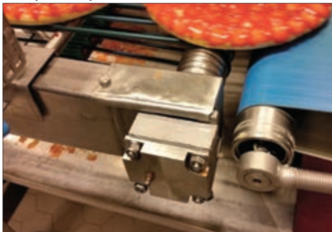
-Image1.jpeg - łożyska Molded-Oil znacząco ograniczyły ilość prac konserwacyjnych związanych z taśmami przenośników w zakładzie produkcji mrożonej pizzy
