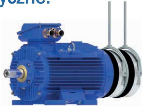
Przykład rozwiązania silnika do pracy S2-30min (bez wewnętrznego wentylatora chłodzenia) z podwójnym hamulcem elektromagnetycznym w wykonaniu teatralnym (o niskim poziomie emitowanego hałasu)
