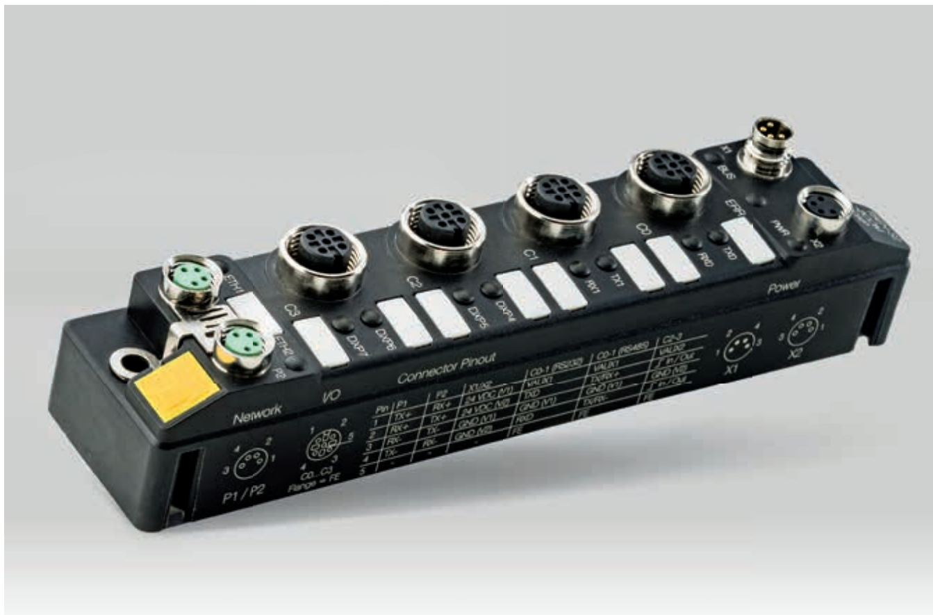
Rys. 2. Za pośrednictwem RS485 na jeden port COM modułu TBEN-S2-2COM można podłączyć maksymalnie 32 silniki. Czujnik wibracji i temperatury można również podłączyć z modułem za pomocą RS485. Wczesne diagnozowanie uszkodzenia łożyska pozwala zaplanować prace konserwacyjne
