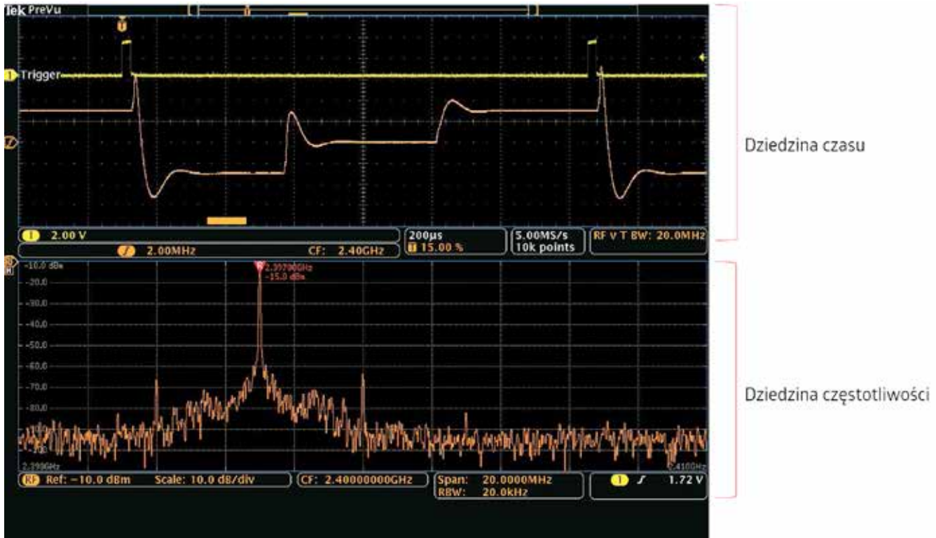
Rys.1. Jednoczesna analiza dwóch dziedzin: częstotliwości oraz czasu
