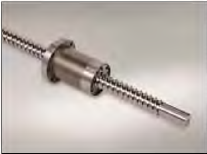
Wysoko obciążalne śruby kulowe serii HTF-SRD z większymi skokami, przeznaczone do jednostek zaciskowych maszyn do formowania wtryskowego, osiągają ultra wysokie prędkości posuwu do 3 m/s.
