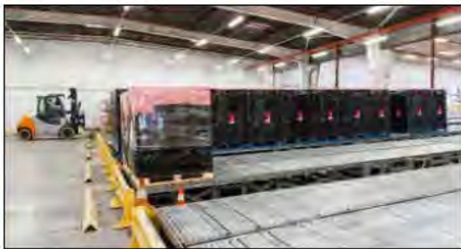
Przenośniki grawitacyjne heavy-duty firmy Interroll
