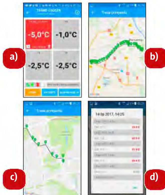
Rys. 2 a). Okno pomiarowe aplikacji Trans-Logger; b). trasa przejechana z Reguła (siedziba firmy LAB-EL), do Warszawy na ulicę Belwederska 14 (długość trasy ok. 14 km); c). powiększony końcowy fragment trasy; d). wyniki pomiarów w konkretnym punkcie trasy - cztery temperatury i czas otwarcia drzwi
