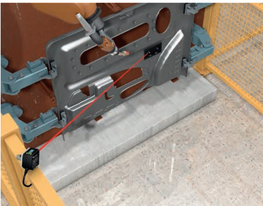
AP1 - Obecność i pozycja komponentu musi zostać potwierdzona przez czujnik LTF12 przed wykonaniem czynności spawania
