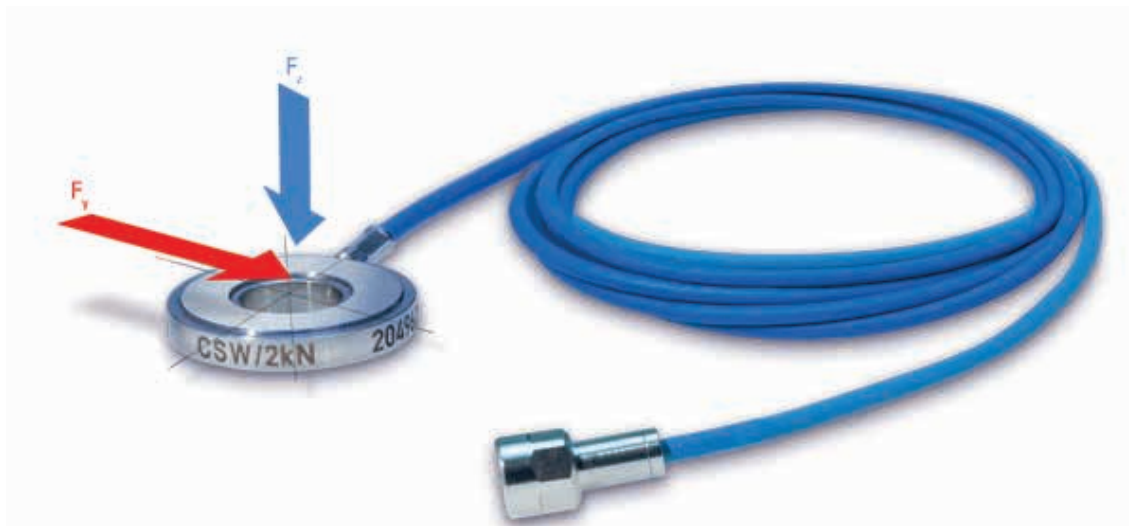
Zdjęcie: Kierunek pomiaru przetwornika CSW. Przetwornik w formie podkładki mierzy siłę działającą w kierunku czerwonej strzałki ( F_y ). Jeżeli potrzebny jest pomiar siły w kierunku niebieskiej strzałki ( F_x ), zalecamy użycie przetworników typu CLP lub CFW.
